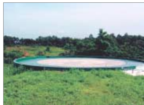
▲ 방향탐지장비 교정시스템 턴테이블 전경
