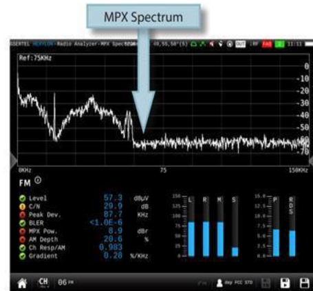
송신기 RF Carrier 동기 및 MPX Spectrum 확인 FM Deviation 확인
